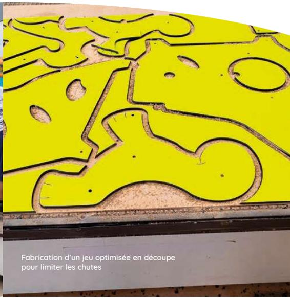
Fabrication d'un jeu optimisée en découpe pour limiter les chutes
